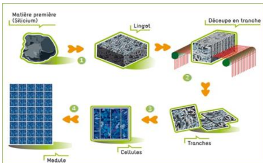
Étapes de fabrication d'un module photovoltaïque (Source : Evasol)
