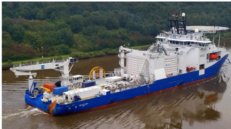
Figure 37 : Le navire câblé « Victoria », Fourni par la NKT
