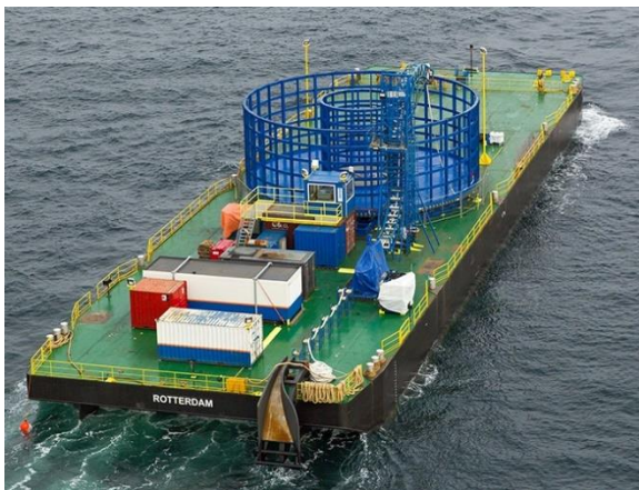
Figure 85 : Barge pour la pose de câbles en eaux peu profondes
